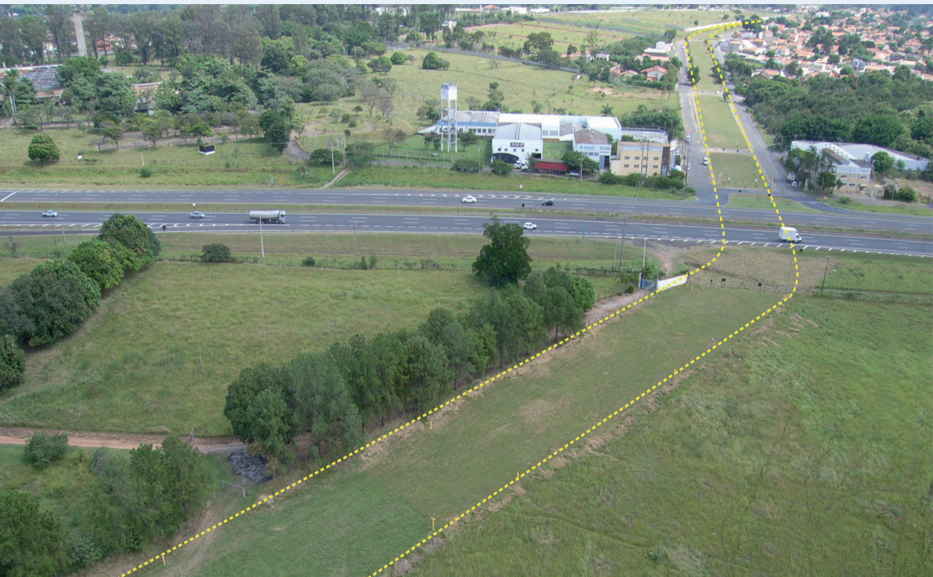
Faixa compartilhada: trechos onde estão instalados mais de um duto para transporte de diferentes produtos.
